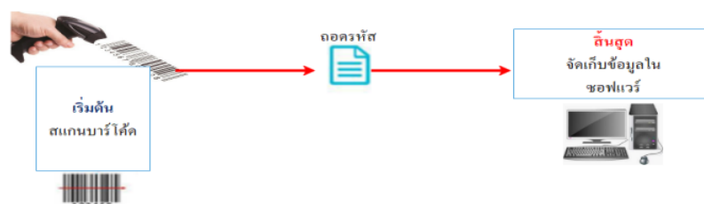
ภาพที่ 2.2 ขั้นตอนการทำงานของเครื่องอ่านบาร์โค้ด
